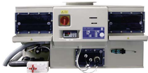
Abluftwäscher für Laborabzug
